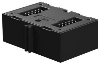
Figure 3.2: The fischertechnik combi sensor 158402
